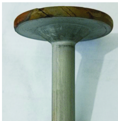
图1 SCM435钢冷镦开裂样品宏观形貌
